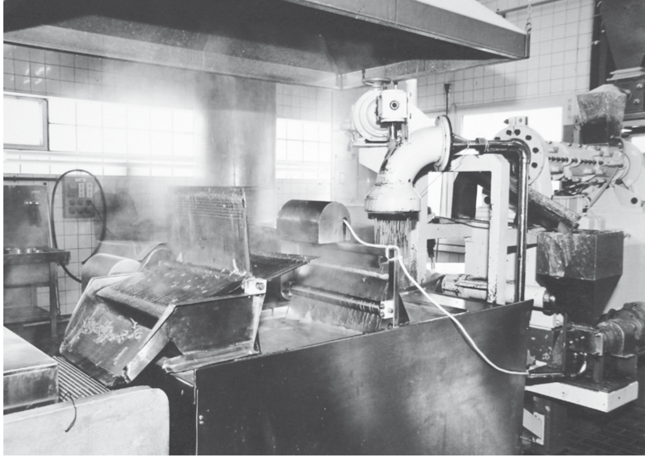
< Maschine zur Herstellung von Pizokel (Spätzli). Foto Anfang 1980er Jahre.
