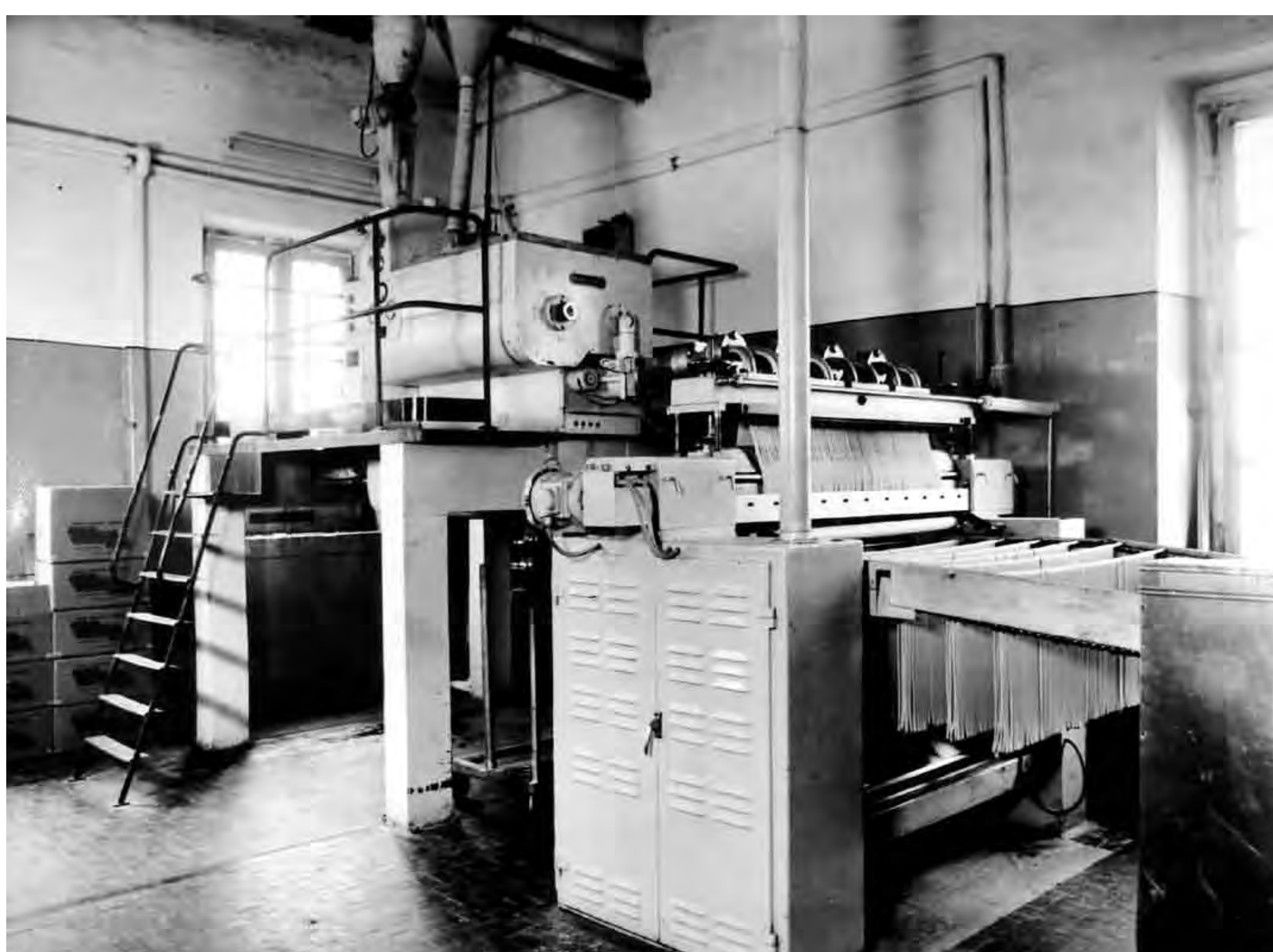
< Automat zur Herstellung von Spaghetti und langen Maccaroni. Foto von 1939.
