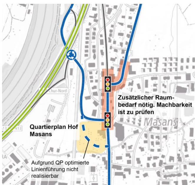
Abbildung 40: Entflechtung des Kreisels Masans auf zwei 3-armige Knoten
